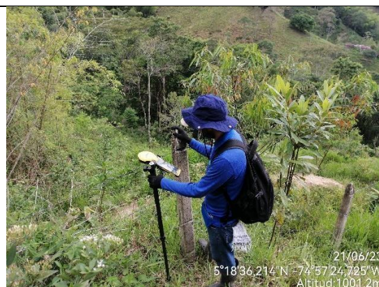
Figura 1.4. Medición con ayuda de jalón y soporte de jalón para mayor precisión en campo.
